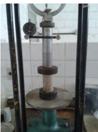
Figura 3. Prensa manual de 50 ton utilizado no teste de resistência à compressão das amostras de argamassa estudadas.
