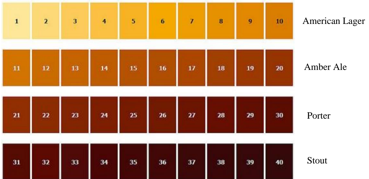
Figura 5. Paleta de cores para a classificação de cor da escala Standard Reference Measurement (SRM) [6] .
