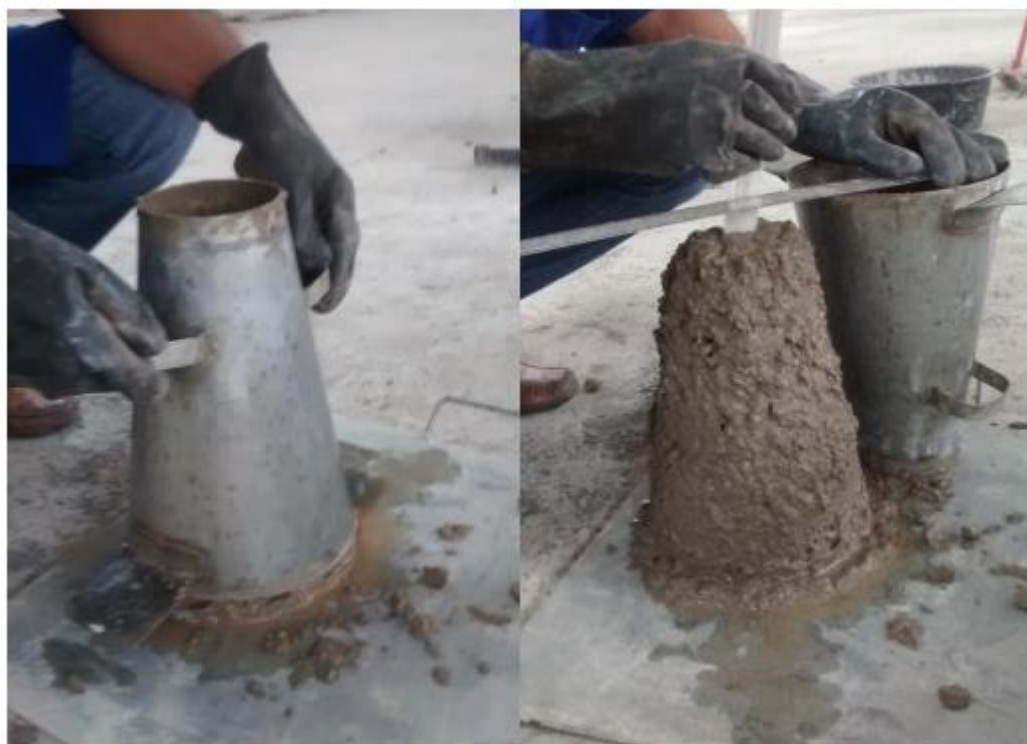
Figura 2: Ensaio de abatimento do tronco de cone.
