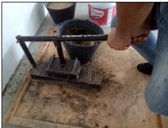
Figura 6 – Prensagem dos Tijolos
