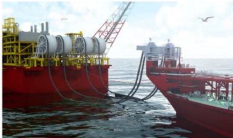
Figura 3 – Método de descarregamento do líquido através de mangueiras criogênicas. Fonte: (Won et al., 2014)
