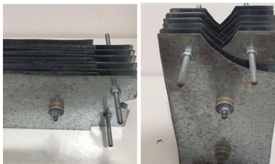
Figura 2 - Arranjo de placas monopolares conectadas em paralelo.
