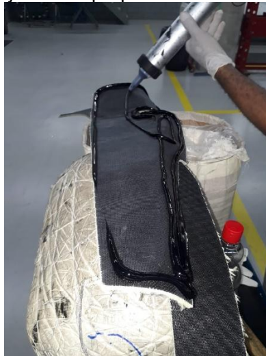
Figura 6 – Peça sendo preparada com Manta de Aramida
