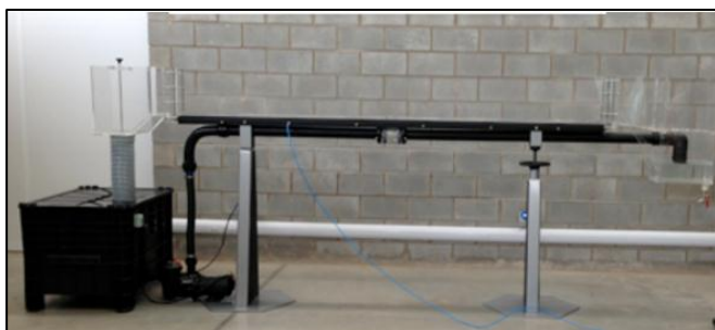
Figura 5: Canal Hidráulico utilizado nos testes de medição das vazões com o Flowmeter .
