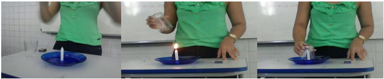
Figura 1. Primeiro experimento, demonstração da importância do oxigênio para o processo de combustão e a liberação do CO_2 . A imagem demonstra os três passos, respectivamente. Foto registrada por uma aluna.
