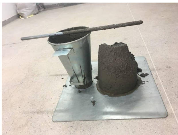
Figura 3- Execução do Slump test para verificação do traço.
