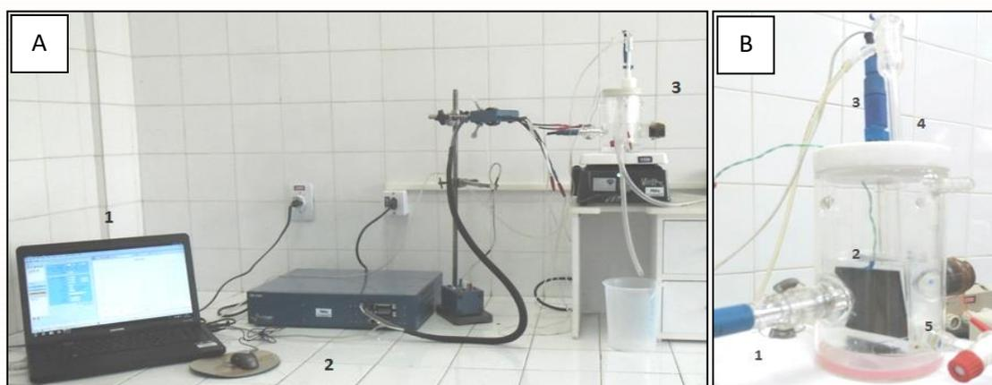
**Figura 2:** Sistema para análises de corrosão (A) composto por computador-transdutor do potenciostato (1), potenciostato (2) e célula eletroquímica (3); Célula eletroquímica (B) composta por contra eletrodo (1) amostr
