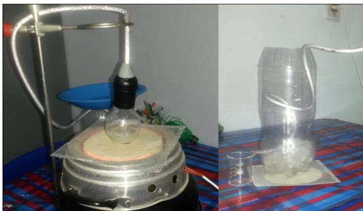
Figura 01: partes do destilador construído com materiais alternativos
