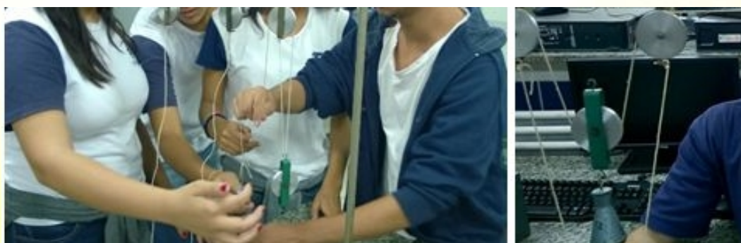
Alunos montando e testando uma associação de polias para mostrar relação de forças.
