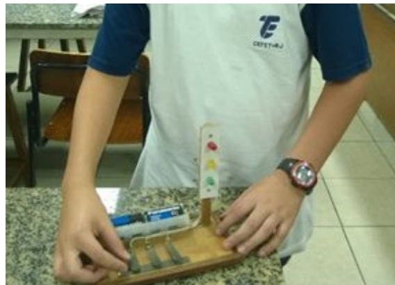
Demonstração da corrente elétrica no acendimento de LEDs num circuito simples.
