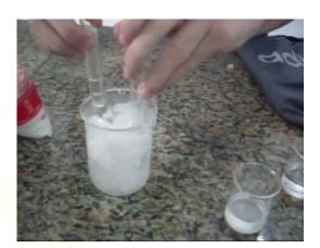
Figura 2: Tubos contendo água destilada e água com sal no béquer com gelo
