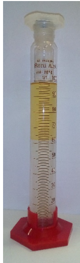
Figura 4: Teste de adulteração da gasolina
