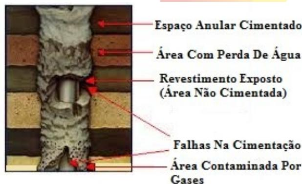
Figura 3: Falha na Cimentação
