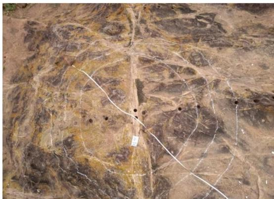
Figura 4: *Scanline* circular para o levantamento de atributos no afloramento 2, em uma região do afloramento com uma grande intensidade de deformação.
