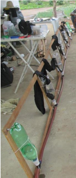
Figura 3: SISCAFI montado em uma estrutura de madeira, para testes, antes de ser colocado no solo.
