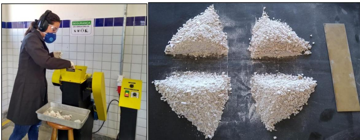
**Figura 2–A)** Primeira redução granulométrica em britador de mandíbulas. **B)** Quarteamento do material fragmentado através do método de pilha cônica.
