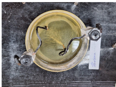
Figura 3 - Recipiente com dois dipolos, conectados ao gerador de Van der Graaf por fios de cobre.
