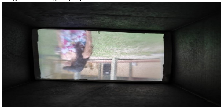
Figura 3 - Imagem projetada invertida no interior da câmara escura
