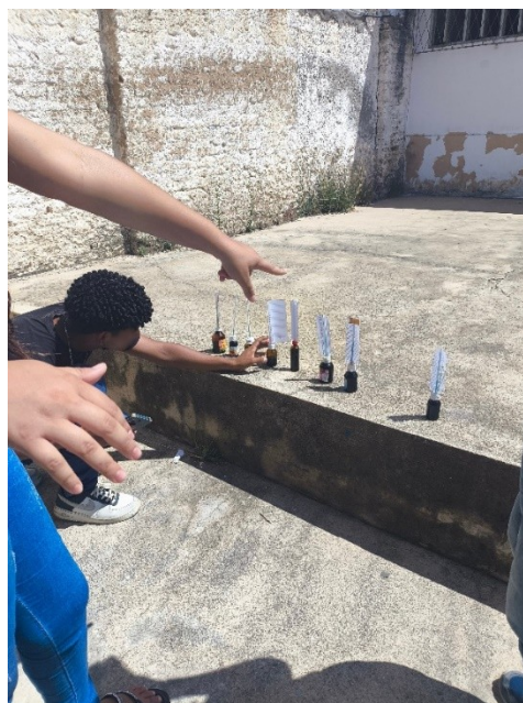
Figura 3 – Teste do termômetro caseiro em ambiente externo para observação da dilatação do líquido sob a temperatura ambiente.
