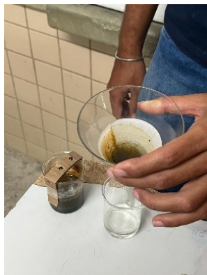
Imagem 6 – Filtração dos flocos (fonte própria)
