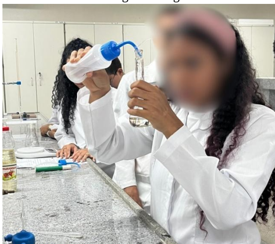
Figura 1: Estudante diluindo o vinagre com água destilada no balão volumétrico.
