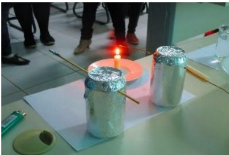
Figura 1 - Experimento de condução de calor com fio de cobre e madeira.
