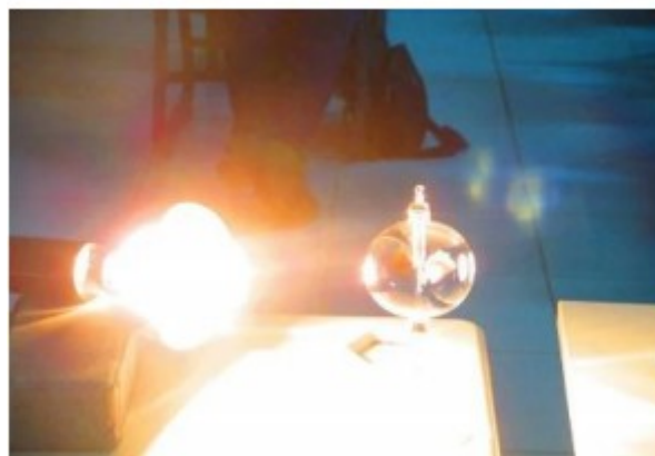
Figura 3 - Experimento de radiação com o radiômetro.
