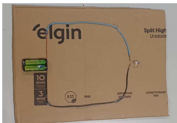
Figura 6: Terceiro circuito elétrico com defeito, pilhas invertidas no adaptador. Fonte: Elaborado pelo autor.
