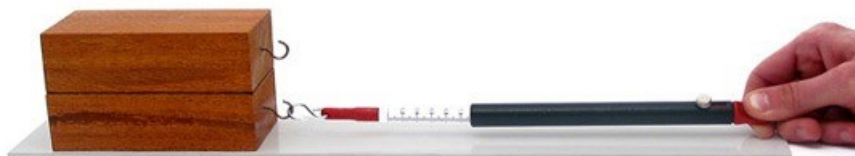
Figura 2: Utilização do dinamômetro para medir a força de atrito em superfície horizontal.
