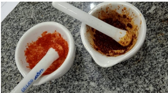
Figura 2: Extração de pigmentos do urucum verde e seco , evidenciando a variação de tonalidades obtidas em função do estágio de maturação dos frutos.
