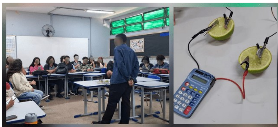
Figura 1: Experimento demonstrativo-investigativo da Bateria de limão
