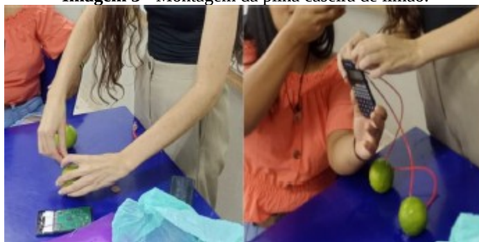
Imagem 3 - Montagem da pilha caseira de limão.
