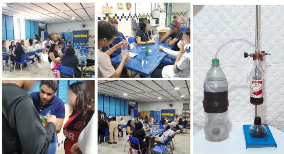
Figura 3: Montagem do destilador com materiais alternativos
