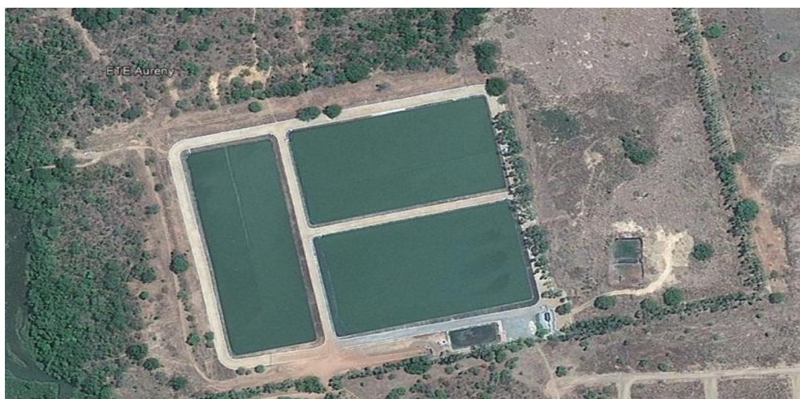
Figura 1 - Vista aérea das lagoas de estabilização em série da ETE Aurenny, Setor Bertaville, Palmas (TO).
