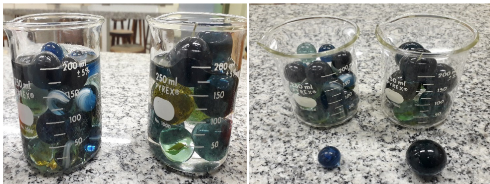
Figura 3 – Registros fotográficos dos procedimentos realizados no experimento demonstrativo realizado para modelizar a permeabilidade de solos com grãos pequenos e com grãos grandes. Os grãos dos solos são representados pelas bolas de gude.
