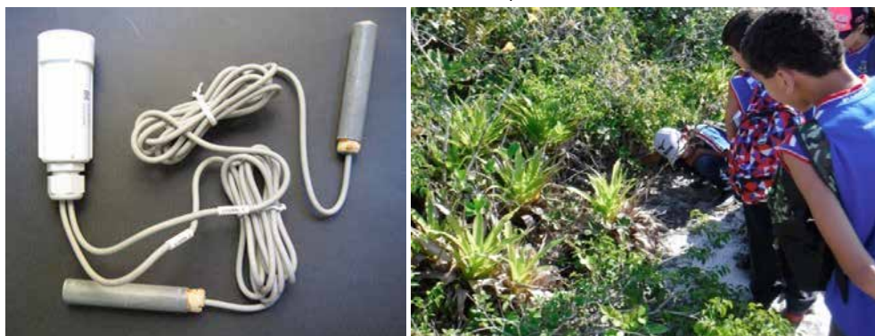
Figura 1: Exemplar de Hobbo Data Logger, com dois modelos de cano de PVC acoplados (A). Alunos buscando o melhor local para se colocar os modelos.
