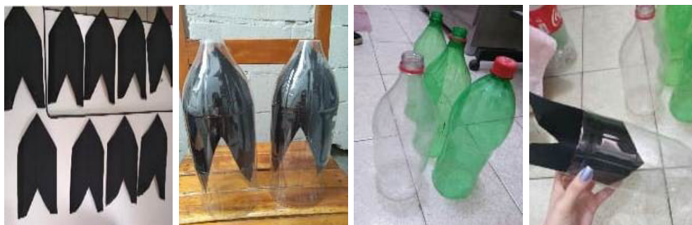
Figura 2. Etapas de montagem do aquecedor solar
