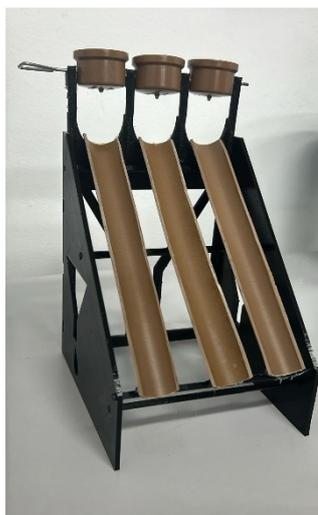
Figura 1. Rampa de viscosidade
