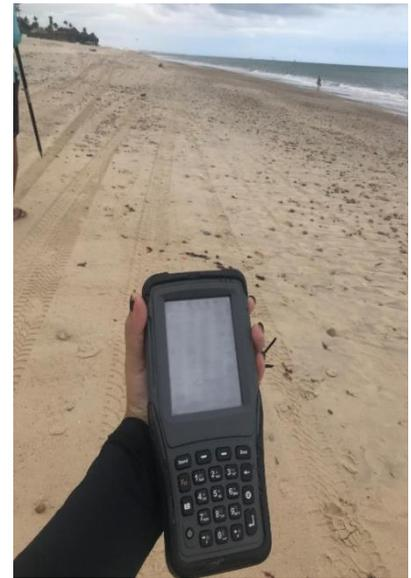
**Figura 5: Coletora digital.**
