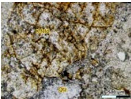
Padrão de fraturamento do quartzo se altera, com os espaçamentos preenchidos com argila entre os fragmentos maiores; a incidência de fraturas internas nos minerais diminui. Volta a ter ocorrência de biotita, onde as mesmas se apresentam com aspecto “desfiado”. Há ocorrência de percolação de material de alteração avermelhado entre as fraturas dos minerais reliquiais novamente, os mesmos se encontram com relevo bem rente ao do material fino, se diferenciando principalmente por essas fraturas.
