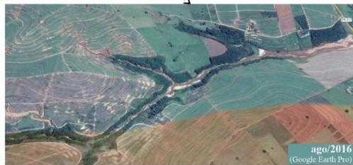
Bancos de areia localizados a jusante na rede de drenagem, resultantes de processos de transporte e deposição de sedimentos associados à erosão hídrica. Observam-se feições erosivas superficiais, tanto laminares quanto em sulcos, indicativas de perda de solo e instabilidade da cobertura superficial.
