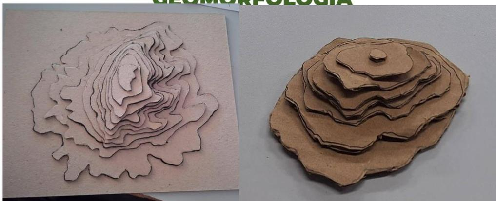
**Figuras 14 e 15** – Maquetes da Serra de Itabaiana com diferentes intervalos entre as curvas de nível.
