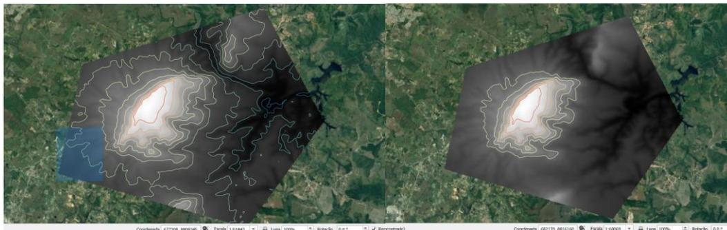
**Figuras 6 e 7** – Curvas de nível geradas com equidistância de 60 metros sobre a Serra de Itabaiana.
