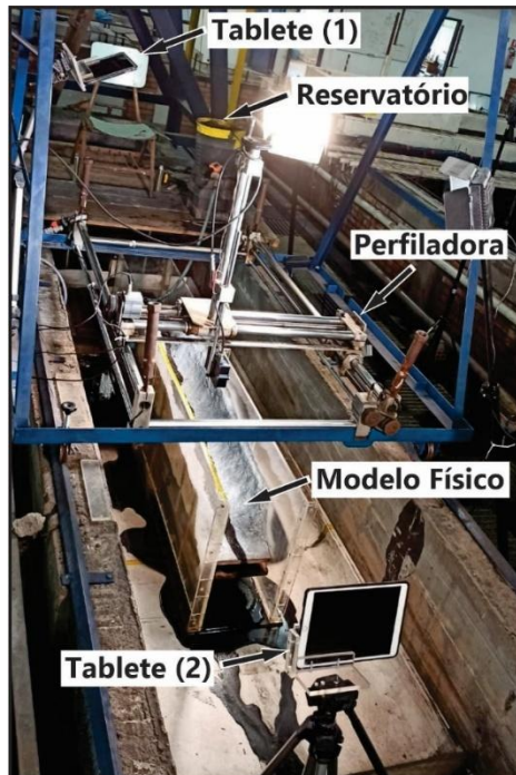
Figura 2. Modelo físico de voçoroca. Tabletes de filmagem, perfiladora e reservatório utilizados na experimentação. Acoplado ao reservatório há registro de esfera de pvc (20 mm – ½) para liberação da mistura e registro regulador da vazão tipo esfera metálico (dn 15 – ½). A injeção da mistura ocorreu por meio de mangueira (dn 2 mm).
