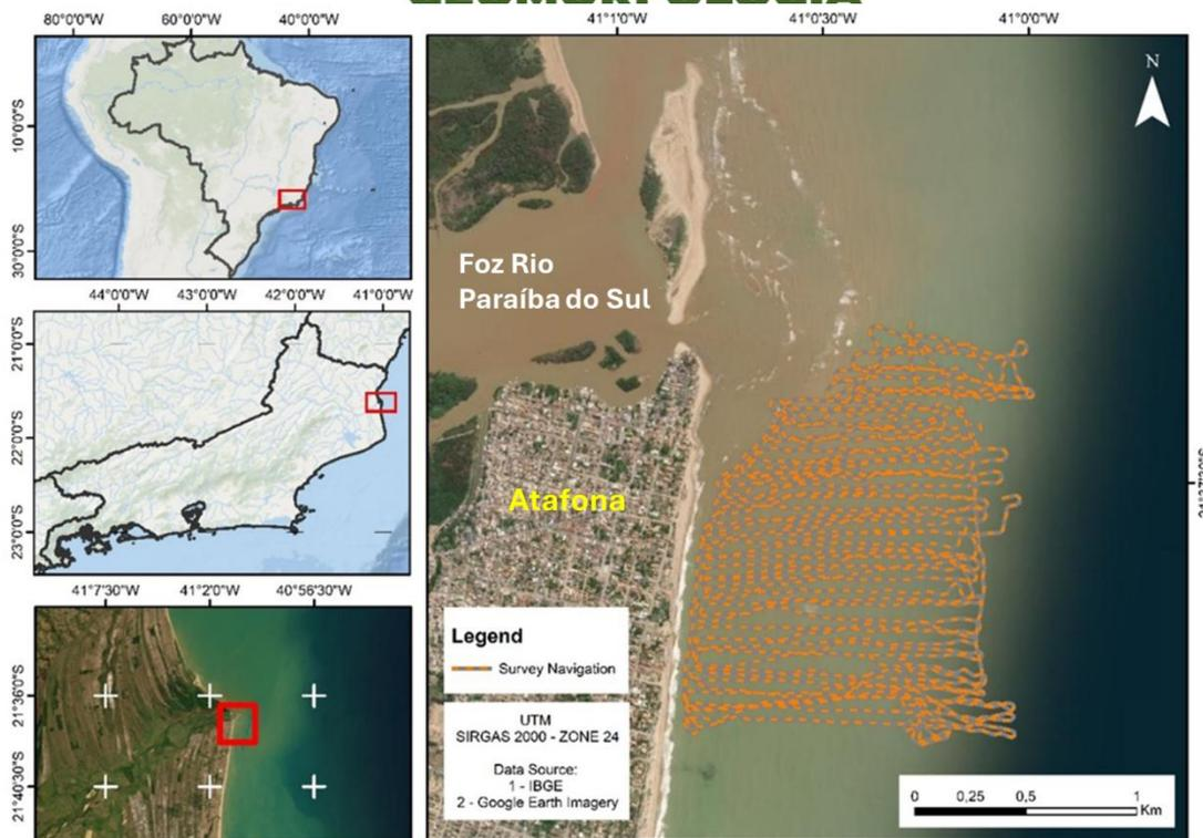
Figura 1. Localização da cidade de Atafona junto a margem direita da foz do rio Paraíba do Sul. As linhas tracejadas indicam a trajetória de navegação realizada durante o levantamento sonográfico na zona submarina adjacente.
