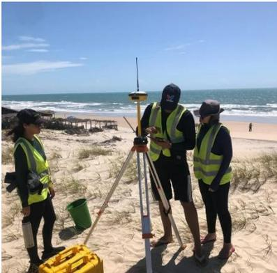
Figura 3: Instalação da base.
