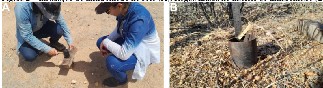
Figura 2 – Instalação do infiltrômetro no solo (A); Régua fixada no interior do infiltrômetro (B)
