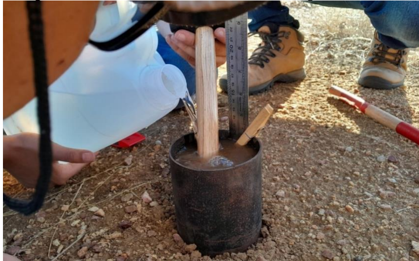
Figura 3 – Preenchimento do infiltrômetro com água até os 10 cm
