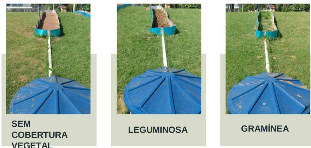
Figura 2: fotos das parcelas de erosão respectivamente: SC (sem cobertura), LEG (leguminosa), GR (gramínea).
