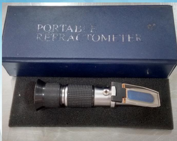
**Figura 2.** Refratômetro manual utilizado para obtenção dos sólidos solúveis (°Brix).
