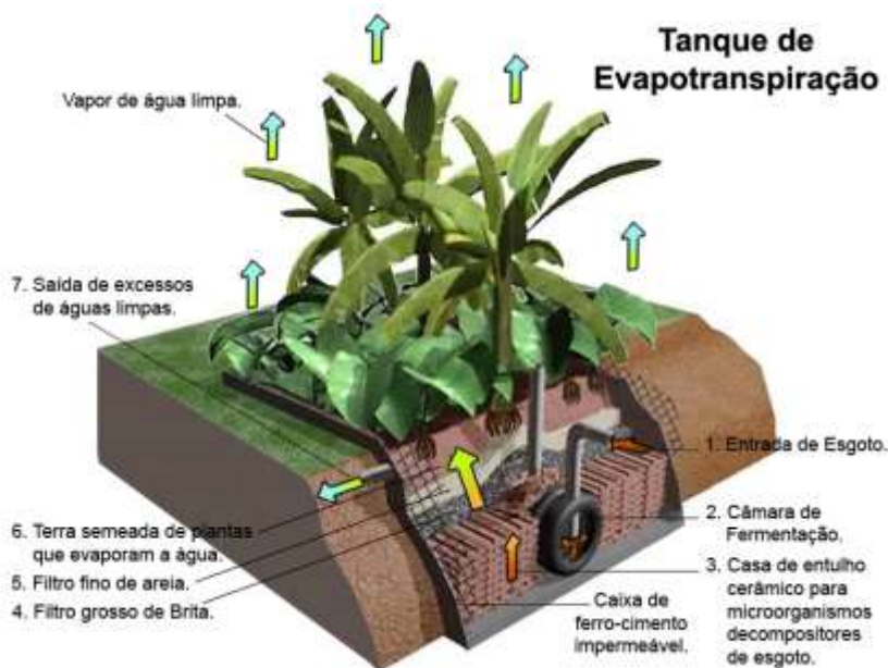
Figura 1. Tanque de Evapotranspiração. Fonte: eco eficientes disponível em: http://www.ecoeficientes.com.br/bet-faca-voce-mesmo/
