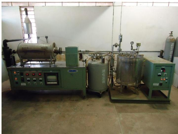
Figura 2: Forno-reator tubular de leito fixo com rampa de aquecimento digital em atmosfera de  $\text{N}_2$  para pirólise da CHINO, adaptado á caldeira.
