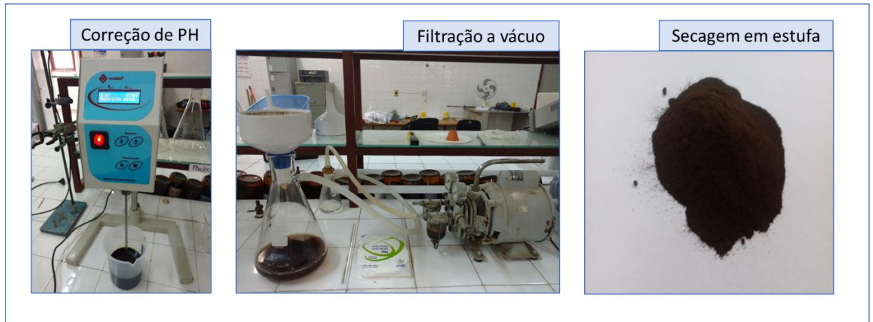
Figura 1: Etapas para obtenção da lignina utilizada na pesquisa
