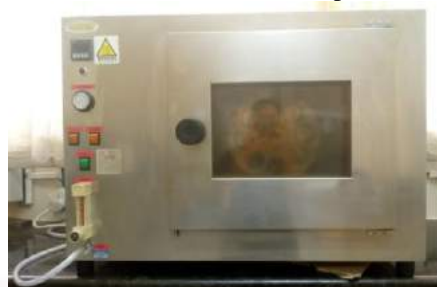
Figura 8 - Envelhecimento a curto prazo (RTFOT)
