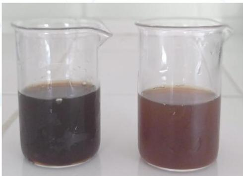
**Figura 8** - Lixiviado bruto e lixiviado alcalinizado com cal hidratada
