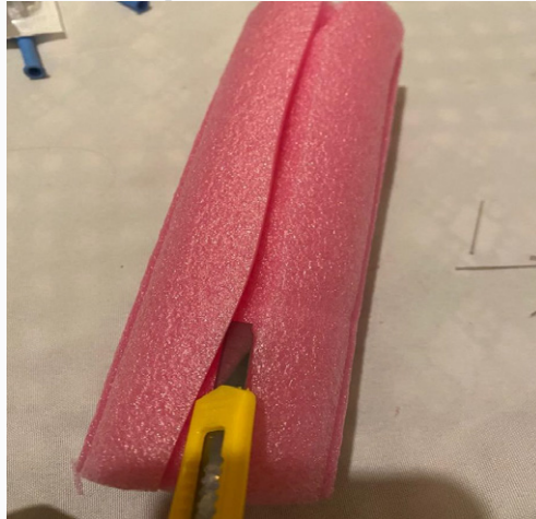
Figura 6. Primeira etapa da produção: corte do Polietileno (flutuante / macarrão de piscina)
