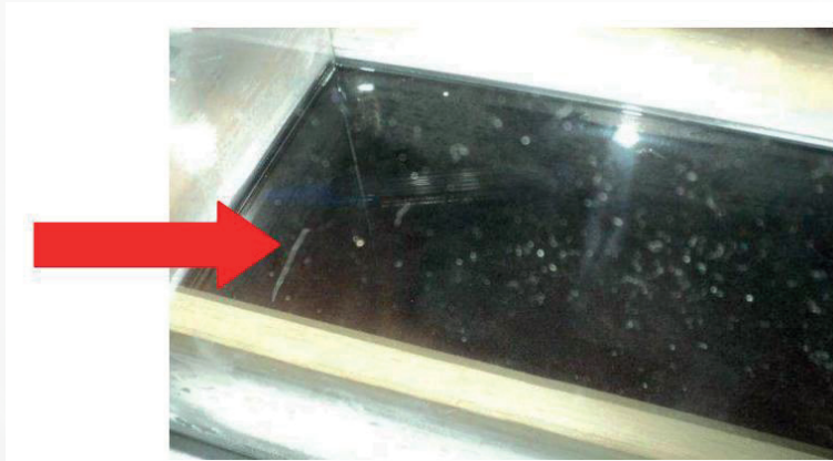
Figura 5: Identificação de um evento de interação da radiação com a matéria
