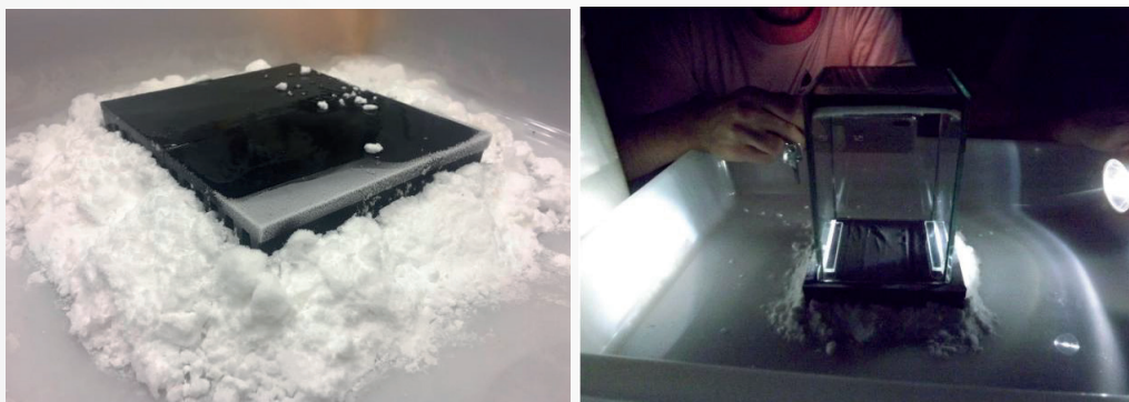
Figura 9: Gelo e dissipadores e a câmara de nuvens construída
